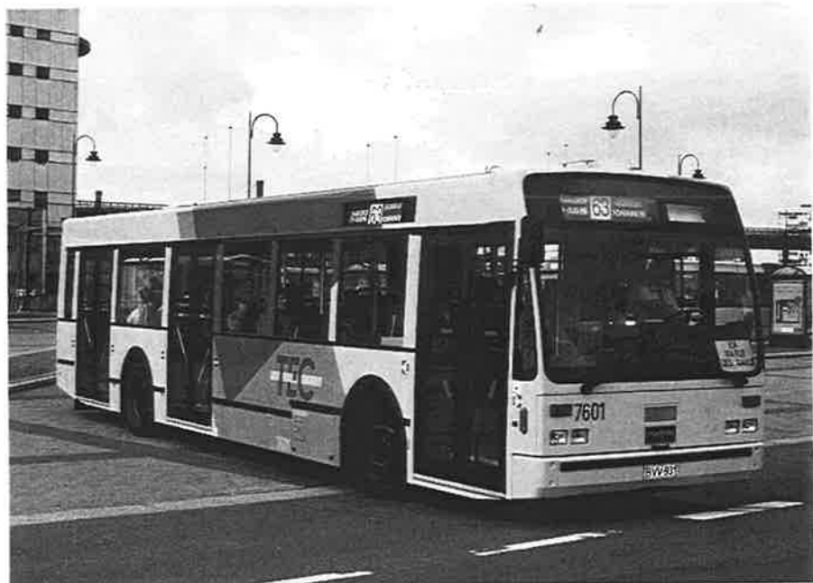
De 7601 met Caterpillarmotor is ondanks zijn hoge dakrand een type A500. Let ook op de plaats van de middendeur. Charleroi Sud 4 6 1998. Foto : Luc Couscheir.
